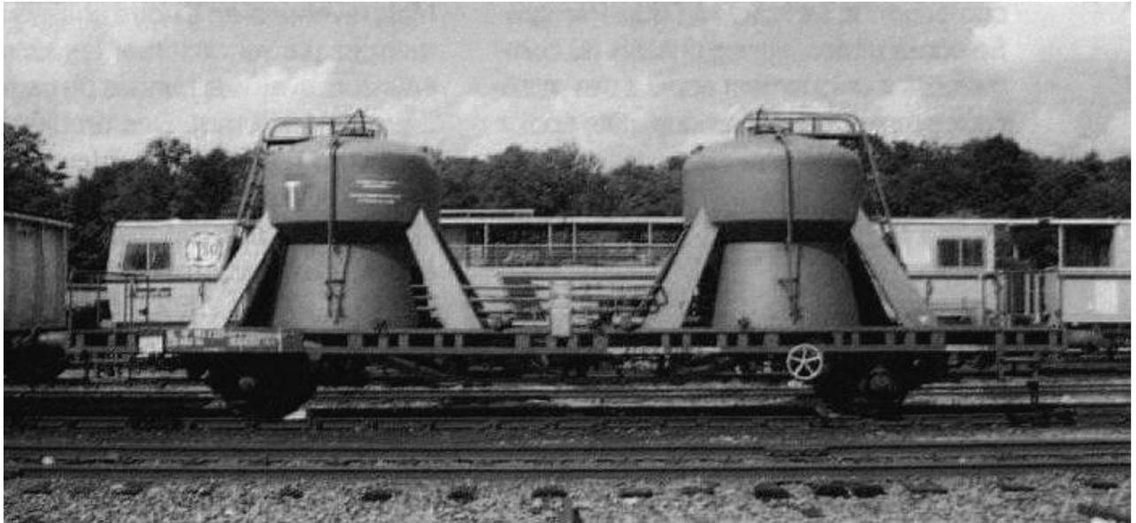
Pour transporter le sable du site de fabrication vers les sableries la SNCF à utilisé des éléments qu'elle possédait, des châssis de wagons "Stuttgart" de provenance dommage de guerre et des containers dit "Lazareth" qui étaient auparavant affectés aux transports de pulvérulents, et dont une grande partie appartenant à la 'CNC' étaient réformés.
