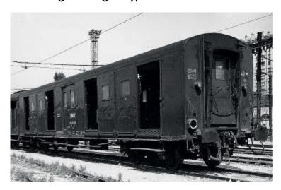
Le fourgon à bogies métallisé ex-PLM de la SNCF est un fourgon à bogies de type Dd, en livrée verte.
