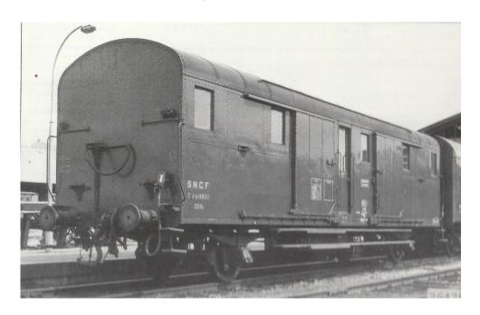
Les fourgons OCEM 32 de la SNCF sont des fourgons à 2 essieux de type Dd, en livrée verte.
