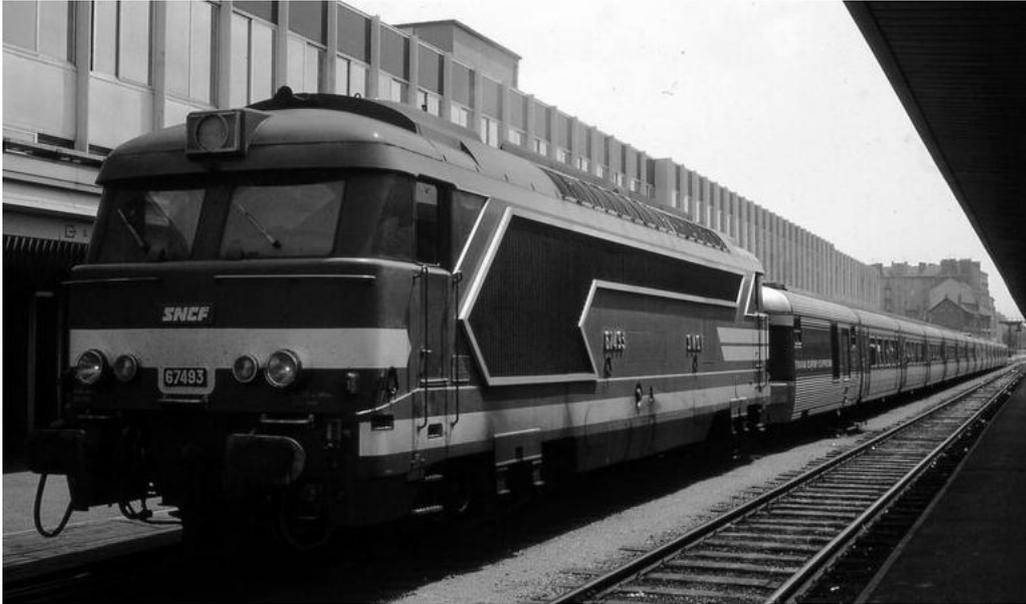
Démunies du chauffage de la rame, les premières BB67000 livrées à partir de 1963 devaient emmener un fourgon chaudière de 30 tonnes pour assurer cette fonction. La SNCF se pencha sur le chauffage électrique, en recourant à l'alternateur de traction et à la ligne de train 1500V.
