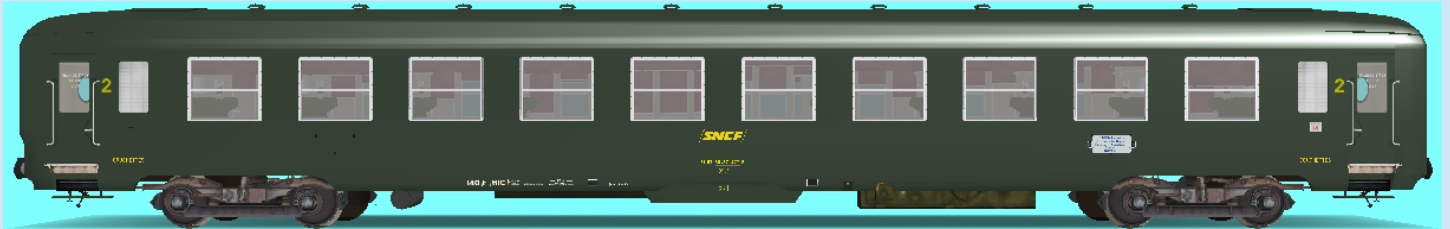
SNCF_DEV_B10_U57E4ab_F2 Époque IV (1968-1980 dans cette livrée) Gérance de Conflans. Équipée de bogies Y20
